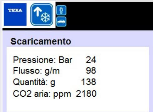
Durante l'operazione di scarico del refrigerante il display visualizza la quantità di refrigerante scaricato e la pressione dell'impianto.
