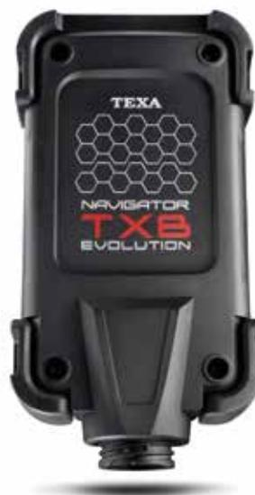
Interfaccia veicolo all'avanguardia, **sviluppata espressamente per l'ambiente motociclistico.** Compatibile con tutti i protocolli attualmente esistenti e tutti i cavi diagnostici BIKE. Permette di registrare anche la **sessione diagnostica in movimento\***.
