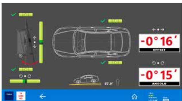
La dicitura "OFFSET" indica quanto l'RCCS 2 sia fuori centro rispetto alla linea mediana del veicolo. "ANGOLO" indica invece di quanto l'angolo di imbarcata della struttura sia fuori centro rispetto al veicolo.
