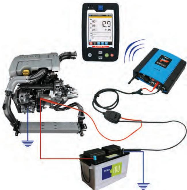
Figura 44: Rilevazione caduta di tensione su cavo di alimentazione del motorino di avviamento
