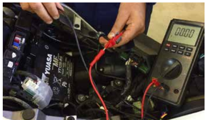
Figura 17: Misura con il multimetro. Il multimetro è impostato sulla misura in ampere. Il cavo nero è collegato al polo negativo della batteria. Il cavo rosso è collegato al cavo negativo dell'impianto elettrico
