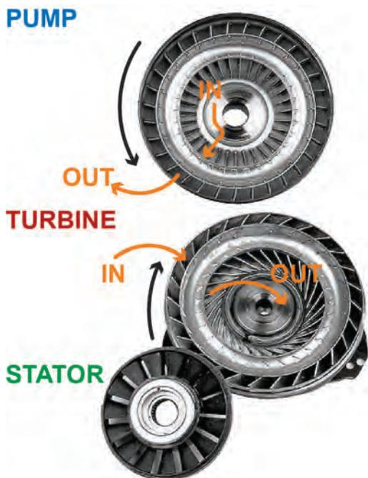
Figura 6: Pompa e turbina del convertitore
