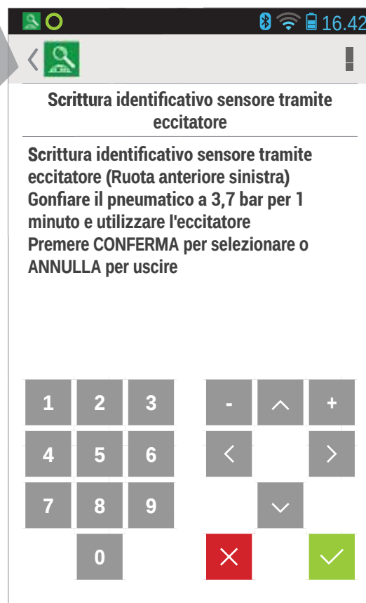
Figura 78: Regolazione: "scrittura identificativo sensore tramite eccitatore". Si utilizza la TPS Key per eccitare il sensore di pressione e forzarlo a trasmettere
