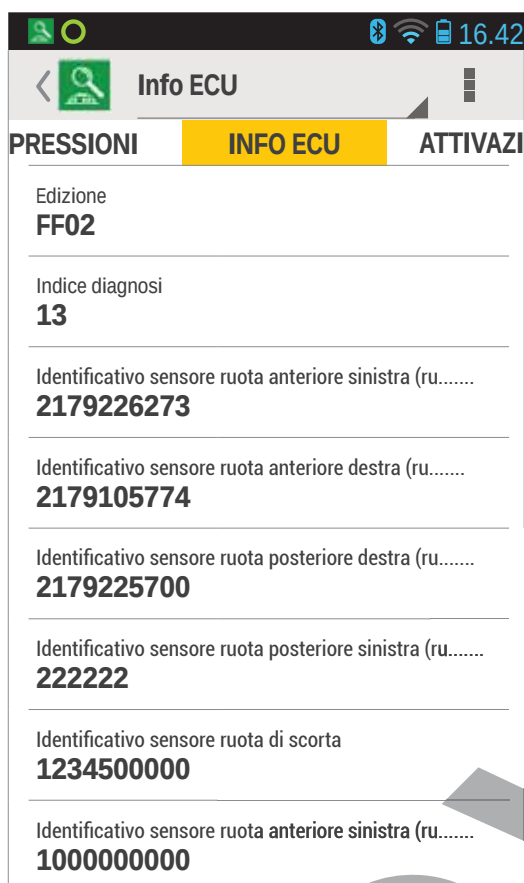
Figura 75: Pagina Info ECU di una centralina TPMS: sono registrati gli ID dei sensori di pressione
