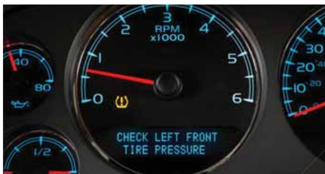
Figura 2: Spia di segnalazione e segnalazione a display di un pneumatico sgonfio
