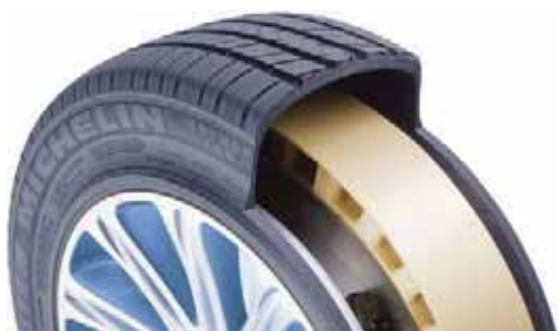
Figura 107: Pneumatico dotato di sistema PAX
