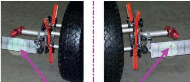
Figura 43: Supporti Ruote Posteriori Haweka con griglia numerata di riferimento per il laser riflesso
