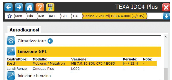
Figura 16: Esempio: l'Alfaromeo Giulietta 1.4Tjet GPL è del tipo OEM con Autodiagnosi da connettore EOBD e gestione tramite normale software di diagnosi IDC4 TEXA
