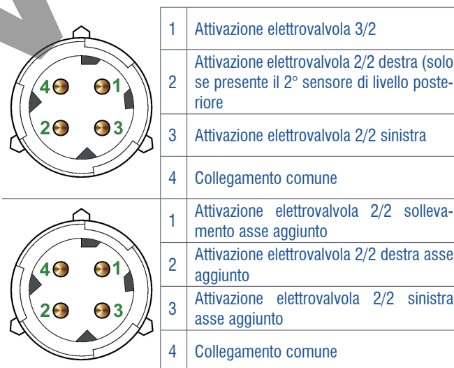
Figura 70: Gruppo elettro distributore asse posteriore e asse aggiunto per il controllo della trazione ottimizzato o per il controllo proporzionale della pressione
