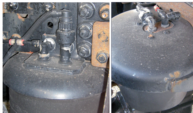
Figura 91: Sensori di pressione: sui soffietti dell'asse posteriore
