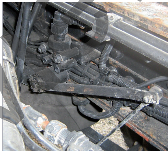
Figura 90: Sensore di Livello anteriore: lato sinistro davanti la ruota; sensori di livello posteriori: sopra l'asse trainante
