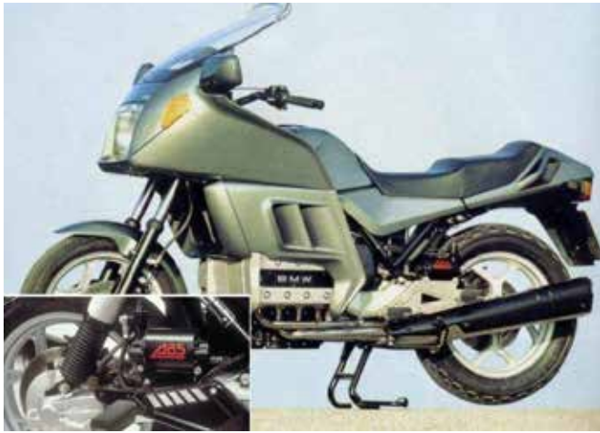
Figura 2: La BMW K100 è stata la prima moto dotata opzionalmente di sistema ABS
