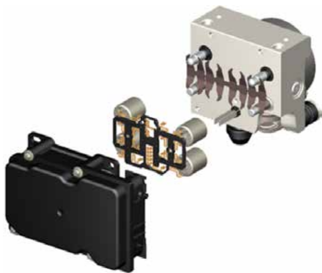
Figura 7: Valvola di ingresso e di scarico nel modulatore idraulico dell'ABS
