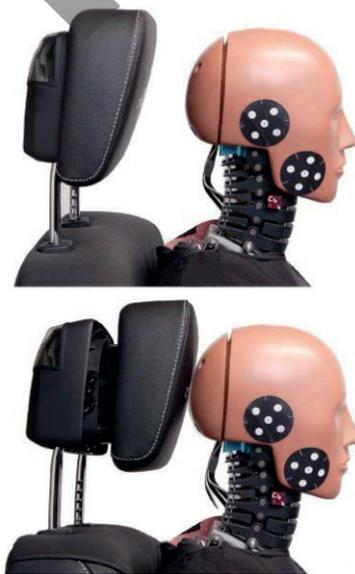
Figura 97: Lo studio dei poggiatesta avviene con un apposito manichino dotato di sensori posizionati lungo il collo
