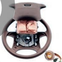
Figura 20: Il modulo airbag è composto da numerosi componenti
