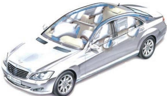
Figura 19: Oggigiorno per assicurare la sicurezza degli occupanti, un'auto può essere equipaggiata con diverse tipologie di dispositivi: Bag frontali, laterali, a tendina, per le ginocchia, antiscivolamento, o addirittura integrati al cofano motore per proteggere i pedoni in caso di investimento.
