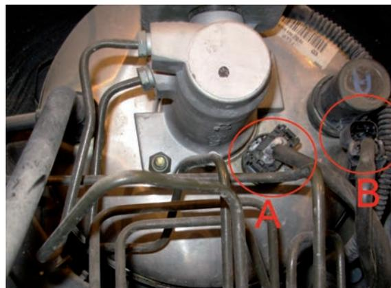
Figura 89: Connettore alla bobina del servofreno attivo (A). Connettore del sensore di posizione della membrana del servofreno (B)
