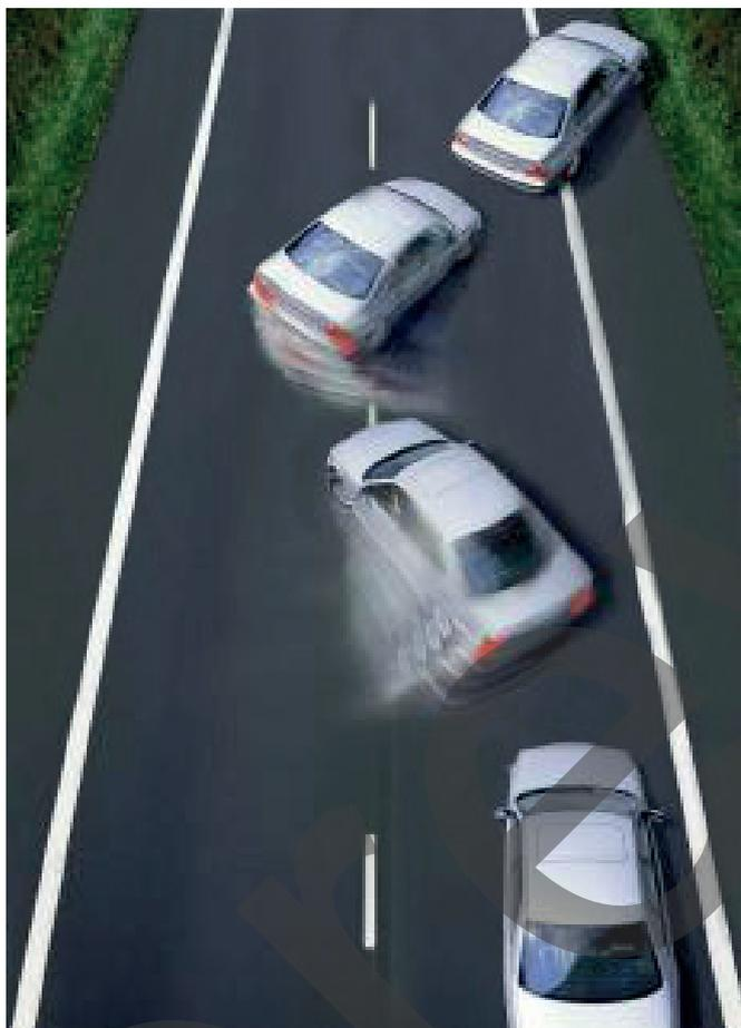
Figura 52: Rapide sterzate per evitare un ostacolo sono le tipiche condizioni di intervento dell'ESC
