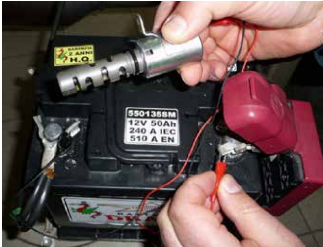
Figura 116: Elettrovalvola OCV smontata e collegata direttamente ai 12 V
