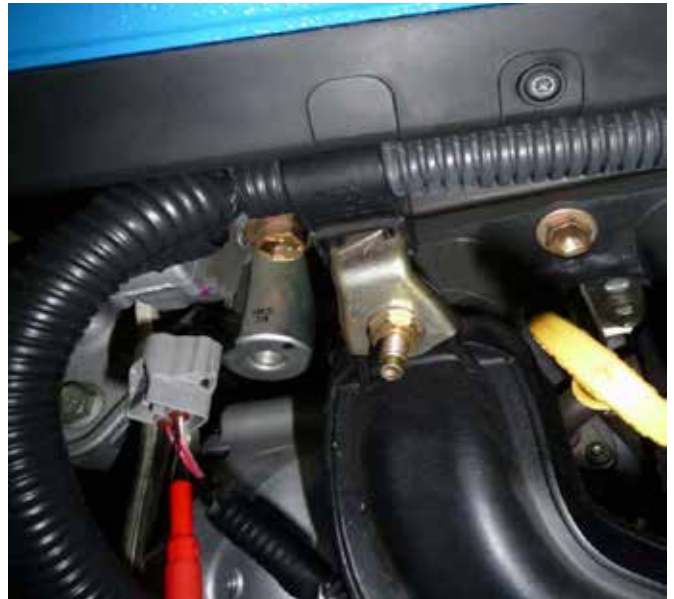
Figura 114: Collegamento dell'oscilloscopio all'elettrovalvola OCV
