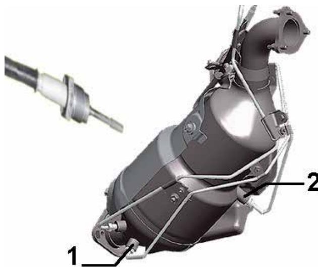
Figura 155: Disposizione sensori temperatura gas di scarico
