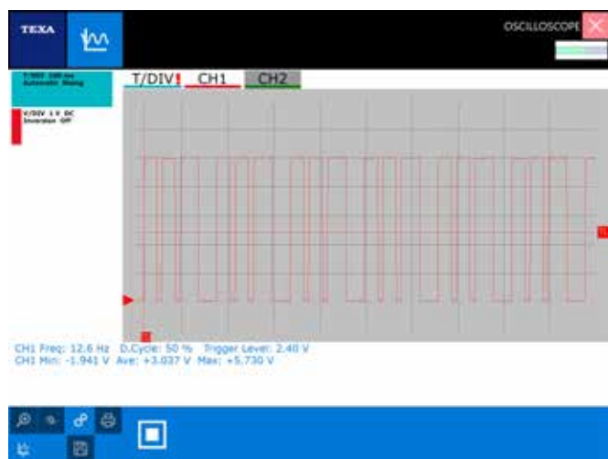
Figura 11: Esempio di segnale in PWM
