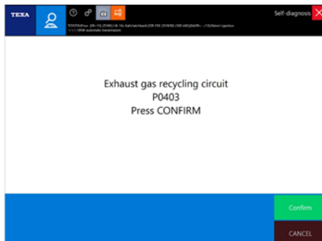
Figura 36: Il dettaglio dell'errore è sempre disponibile tramite doppio click. In questo caso il codice errore P0403 indica che la valvola di ricircolo gas di scarico ha un problema generico
