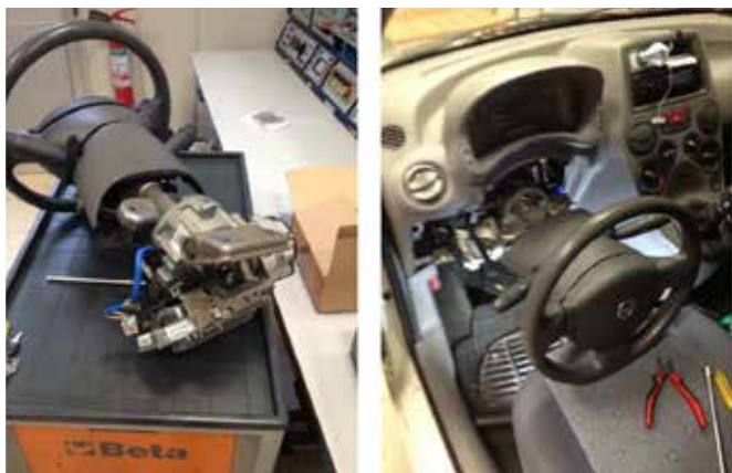
Figura 127: Smontaggio del piantone dello sterzo
