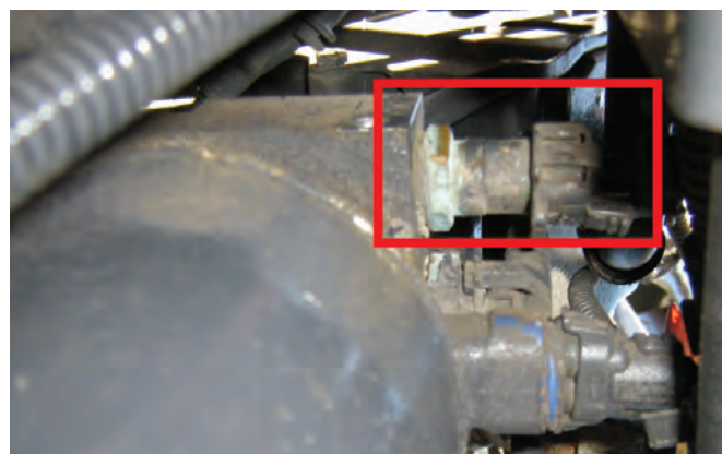
Figura 67: Ubicazione sensore temperatura carburante (vista da sotto)
