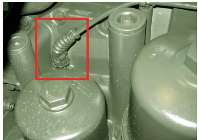
Figura 91: Ubicazione sensore temperatura olio motore
