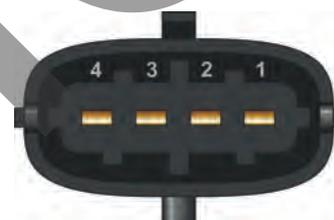
Figura 39: Connessioni Sensore pressione/temperatura sovralimentazione
