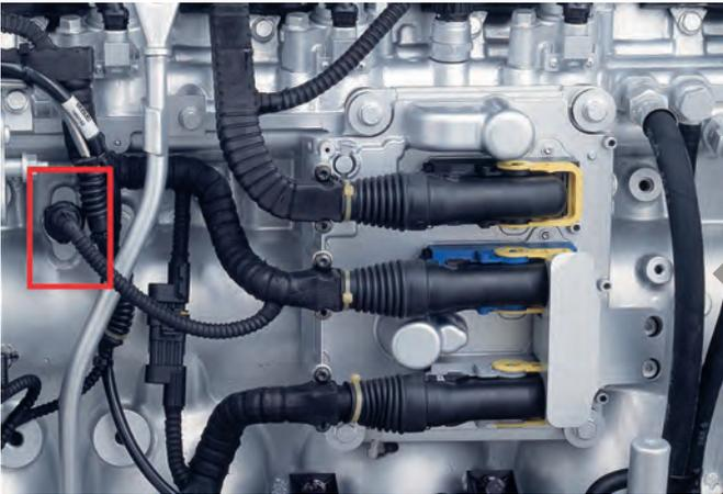
Figura 87: Posizione di montaggio sensore di pressione olio
