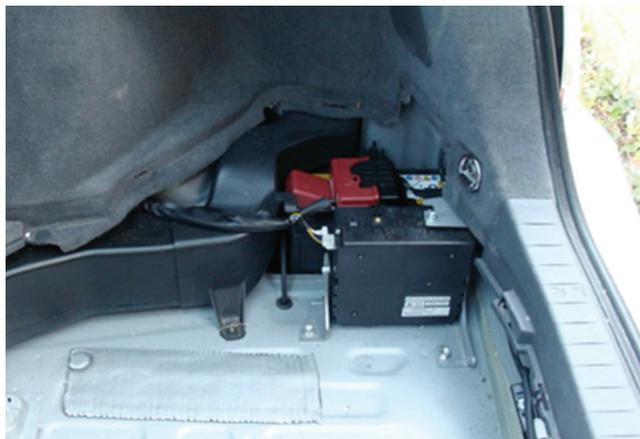
Figura 13: Ubicazione batteria 12 V
