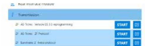
Figura 48: Autodiagnosi cambio AS-Tronic con logica Iveco o ZF
