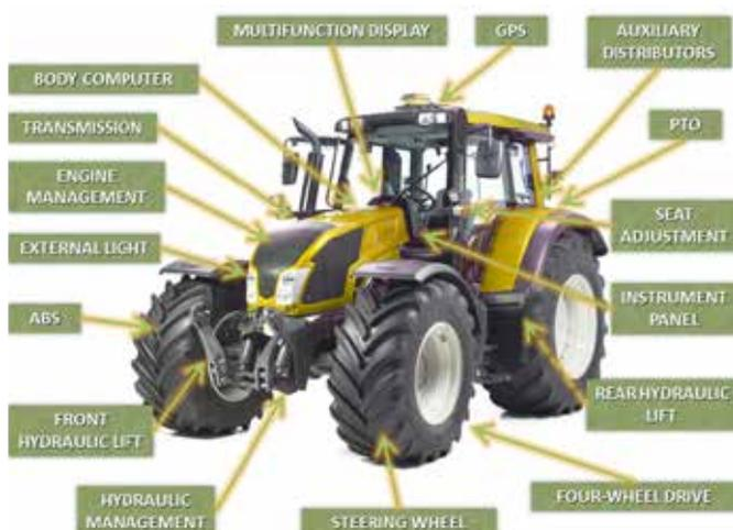
Figura 42: Impianti elettronici sui veicoli Off-Highway
