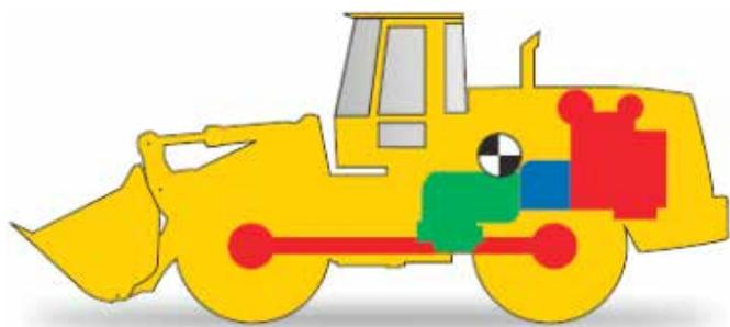
Figura 7: Trasmissione idrocinetica
