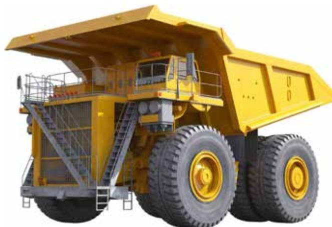
Figura 13: Dumper a telaio rigido
