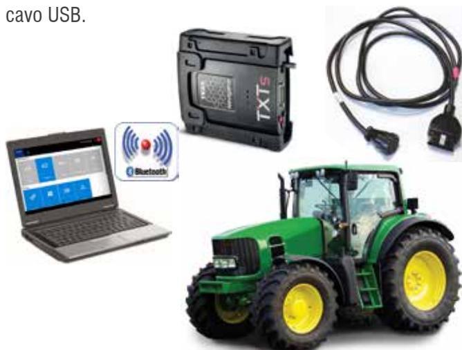
Figura 37: Schema di connessione per l'autodiagnosi
