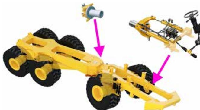
Figura 17: Struttura telaio dumper articolato
