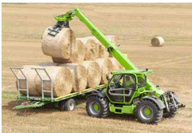
Figura 29: Movimentatore telescopico fisso
