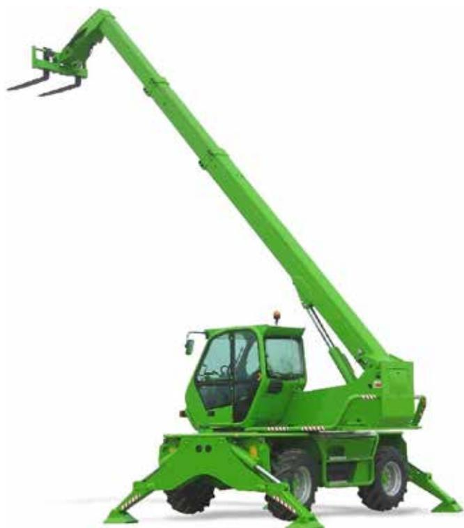
Figura 28: Movimentatore telescopico rotante
