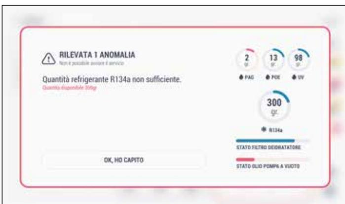
Esempio di errore rilevato: KONFORT TOUCH ha individuato un'anomalia, in questo caso la quantità di refrigerante non è sufficiente.
