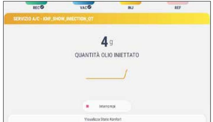
Fase «Iniezione olio»: il sistema inietta nell'impianto del veicolo la corretta quantità di olio destinata a lubrificare l'impianto stesso.
