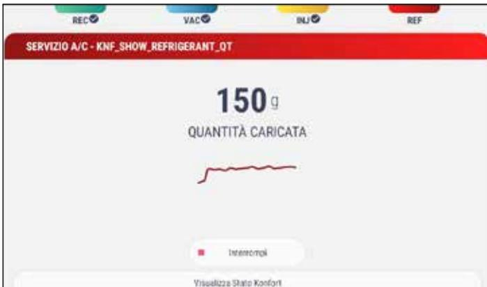
Fase «carica refrigerante»: la stazione provvede all'immissione della corretta quantità di gas nell'impianto del veicolo.
