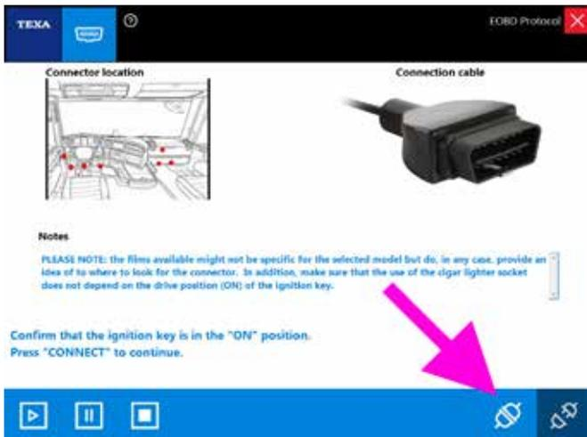
Figura 158: Connessione EOBD Protocol
