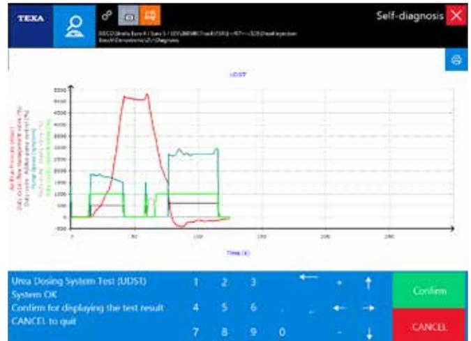
Figura 95: Grafico "Test Sistema Dosaggio Urea (UDST)"
