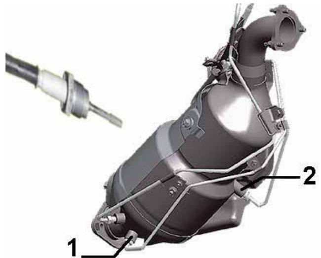
Figura 155: Disposizione sensori temperatura gas di scarico
