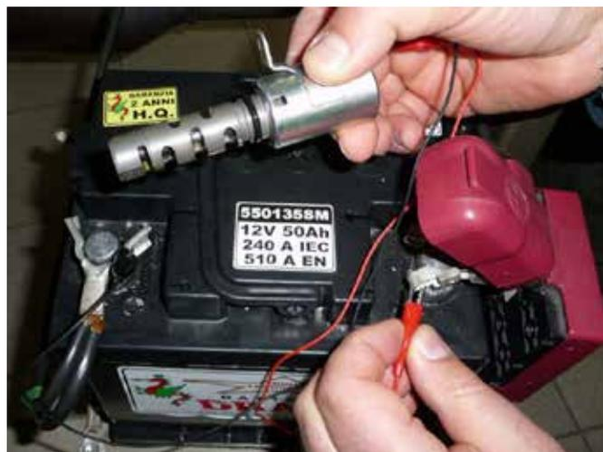
Figura 116: Elettrovalvola OCV smontata e collegata direttamente ai 12 V
