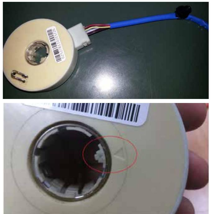
Figura 126: Sensore angolo sterzo. Dettaglio del punto "0" di centraggio del sensore
