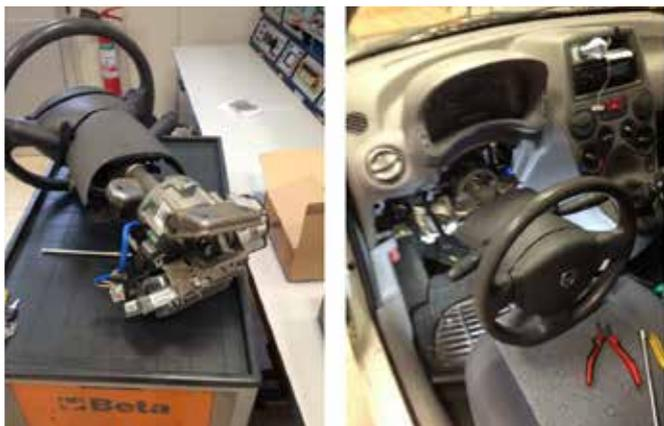
Figura 127: Smontaggio del piantone dello sterzo
