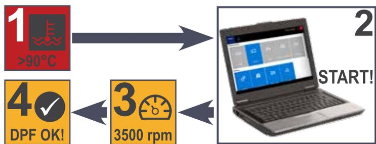
Figura 142: Sequenza operazione per la rigenerazione forzata
