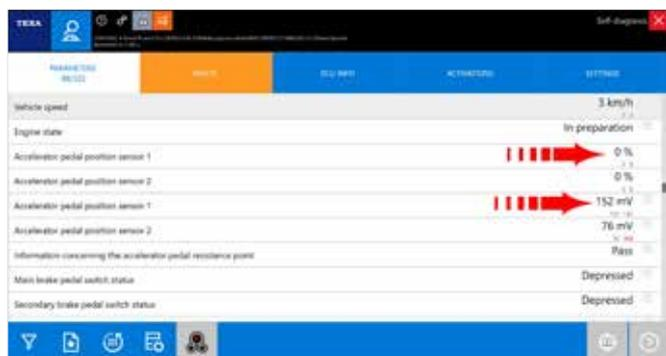
Figura 58: Esempio di parametro posizione pedale acceleratore visto nelle due modalità
