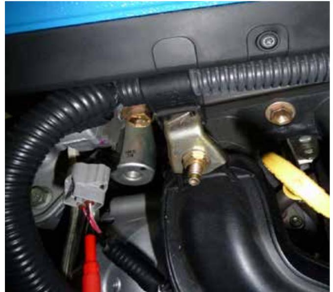
Figura 114: Collegamento dell'oscilloscopio all'elettrovalvola OCV
