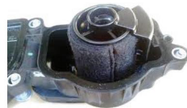
Figura 146: Separatore vapori d'olio
