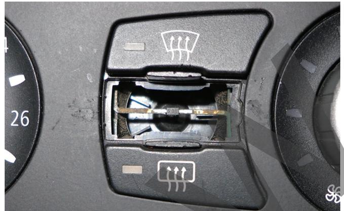
Figura 231: Sonda termica temperatura abitacolo e relativa ventola
