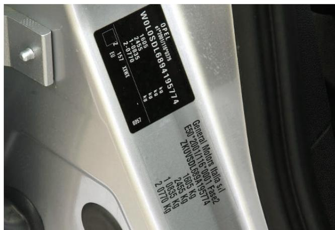
Figura 14: Posizione delle etichette di riconoscimento (nella foto sopra è riportato l'esempio Opel Meriva 1.4 GPL Tech, si vede la dicitura Fase 2)
