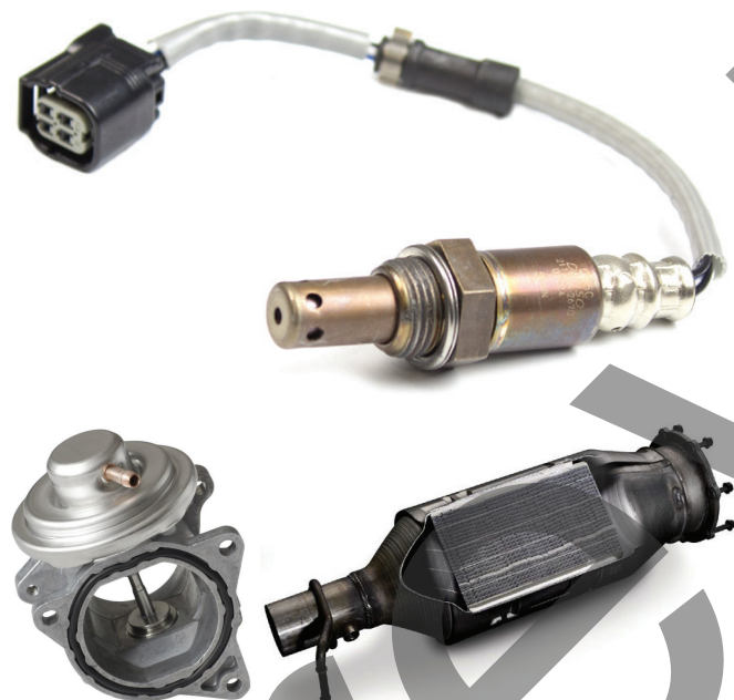
Figura 21: Sonde lambda, EGR, Filtri antiparticolato sono solo alcuni dei componenti che i costruttori hanno dovuto adottare per il rispetto delle sempre più stringenti normative sull'inquinamento
