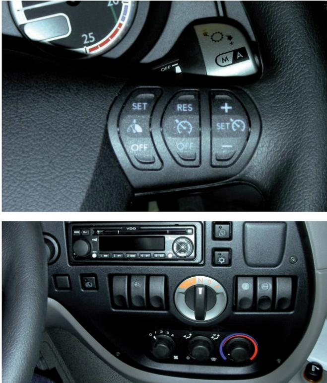
Figura 5: DAF XF105: Selettore marce su leva multifunzione; Selettore marce manuale (N: neutral, D marcia avanti, R marcia indietro, Comandi manovra avanti e indietro)
