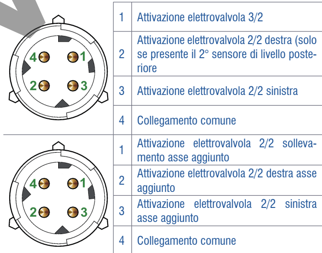
Figura 70: Gruppo elettro distributore asse posteriore e asse aggiunto per il controllo della trazione ottimizzato o per il controllo proporzionale della pressione
