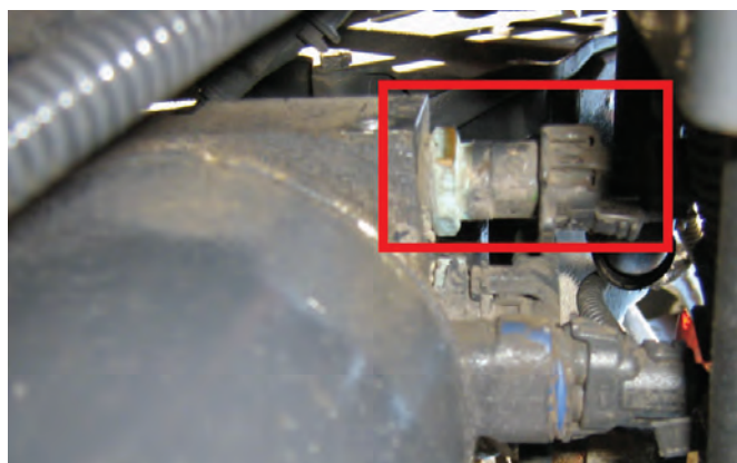
Figura 67: Ubicazione sensore temperatura carburante (vista da sotto)
