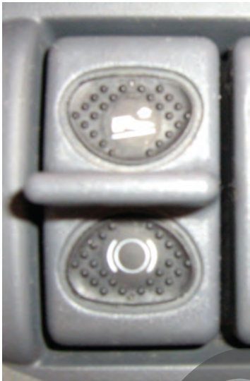
Figura 80: Selettore modalità inserimento Freno motore
