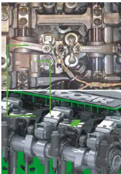
Figura 127: Freno motore MX11
