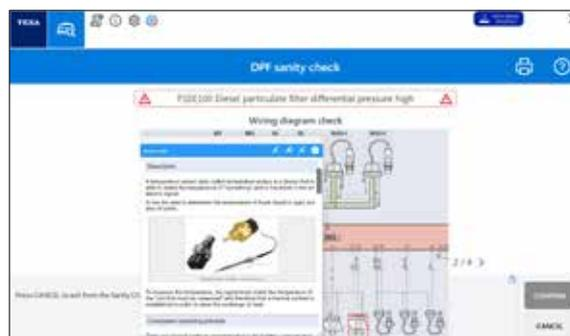
Ulteriori procedure diagnostiche per supportare la risoluzione dell'errore, come schemi elettrici, schede o altre informazioni utili.
