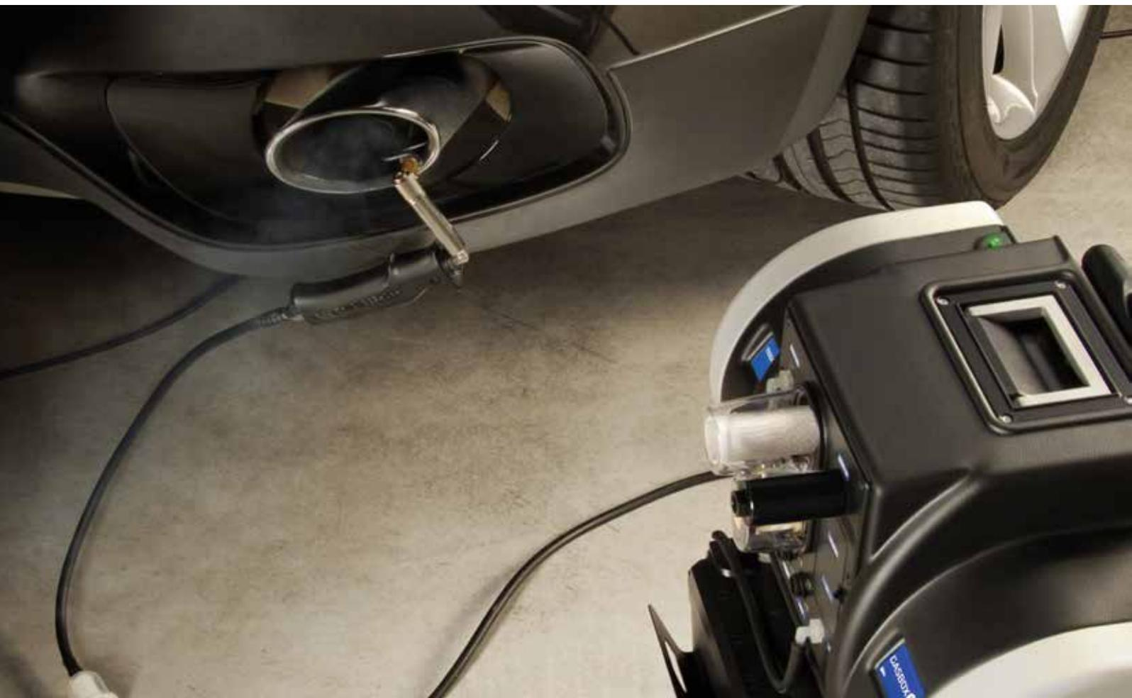
L'offerta TEXA delle attrezzature legate alle verifiche tecniche periodiche dei veicoli a motore comprende gli strumenti **OPABOX Autopower** (opacimetro per la verifica dei fumi emessi dai motori Diesel), **GASBOX2** (analisi gas di scarico per la misura dei valori di motori ad accensione comandata), **RC3** (contagiri per veicoli leggeri e pesanti), **RCM** (contagiri moto) e **NP 01** (contatore di particelle).
