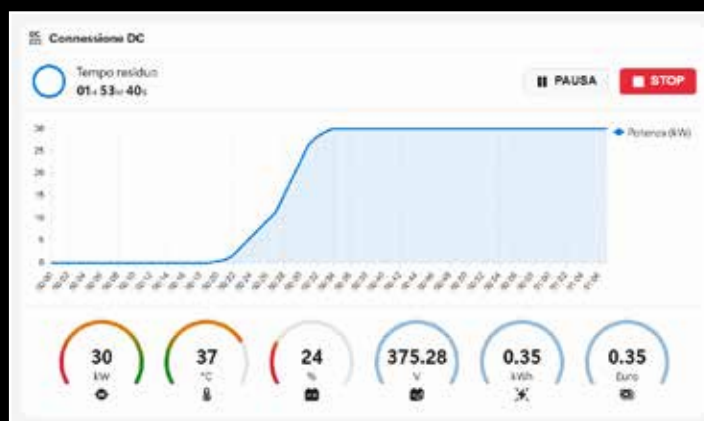
Servizio di ricarica in modalità DC con messaggi di stato
