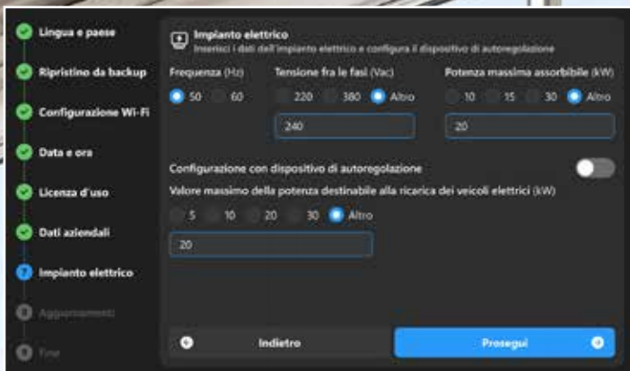
Configurazione dati impianto elettrico officina e dispositivo di regolazione (optional)
